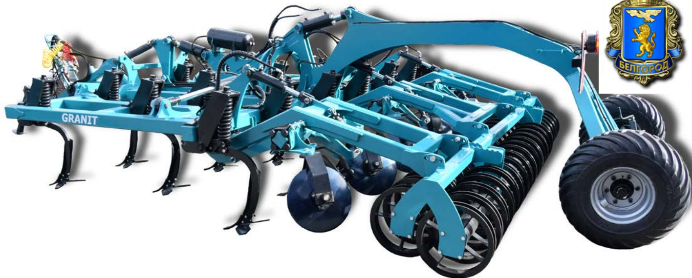
Рабочий орган культиватора с комплектом MulchMix
