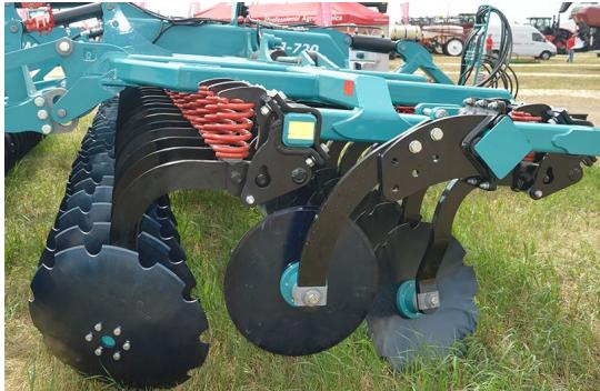
**Рабочий орган:** необслуживаемый пружинный блок, стойка из качественной легированной конструкционной высокоуглеродистой стали, необслуживаемый режущий узел, диск диаметром 610 мм.
