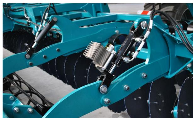
Регулировка глубины обработки осуществляется с помощью клипс, расположенных на штоках гидроцилиндров. Это позволяет удобно и быстро настроить агрегат на необходимую глубину.
