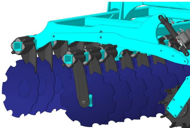
Расстановка рабочих органов позволяет получить высококачественную обработанную поверхность, с максимальным подрезанием растительных остатков и интенсивным перемешиванием. Стойка с резиновым демпфером обеспечивает обработку даже каменистых полей, с небольшим количеством растительных остатков. Подшипниковый узел рабочего органа необслуживаемый, и защищен от пыли и грязи кассетным уплотнителем. Сферические диски с вырезами, диаметром 510 мм. Расстояние между рабочими органами 125 мм.
